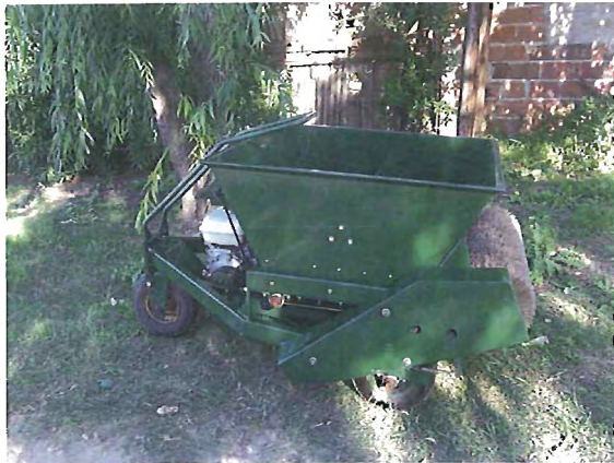
Arenadora y Sacapanes realizando trabajos en tee de salida
